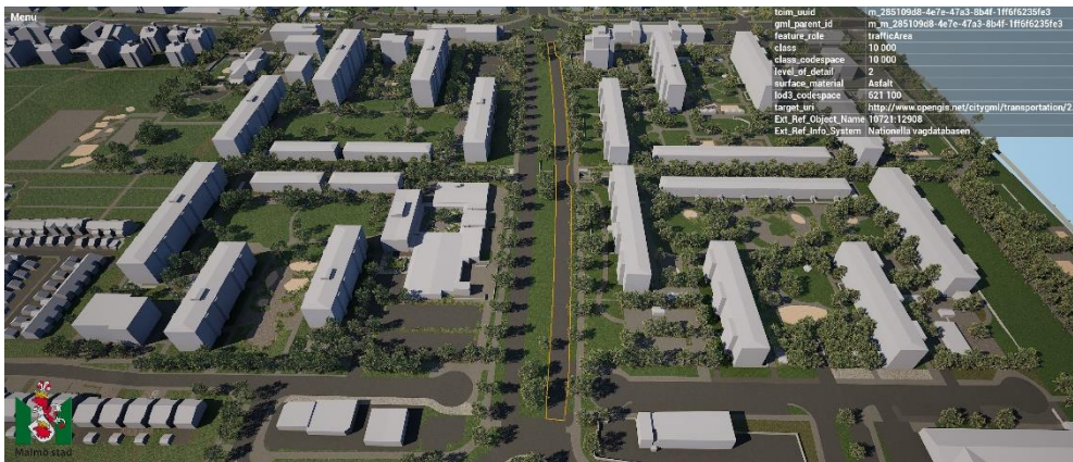
Figur 4.17: Visualisering av testdata för Lorensborg och Bellevue med samtliga CityGML-teman inkluderade. Visualiseringen är genomförd i Unreal Engine. Träd och murar i tagna från testdata i 3CIM1. I det övre högra hörnet visas attributvärdena för den valda vägen (markerad med orange kant)
